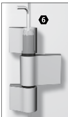
4. Lagerbuchse um \pm 90^\circ drehen bis sie spürbar einrastet (Dichtungsan-druck \pm 0,5 mm)
